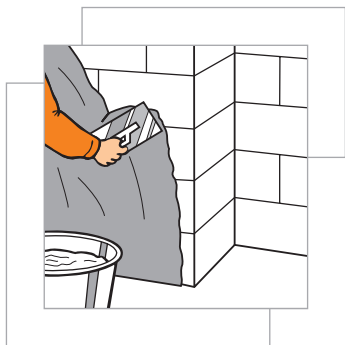
Figura 17: Per i fianchi dei camini, lo strato di legante viene applicato sulla muratura e la lastra FERMACELL vi viene premuta sopra
