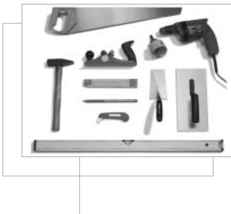
Figura 1: Attrezzi per la lavorazione delle lastre in gessofibra FERMACELL
