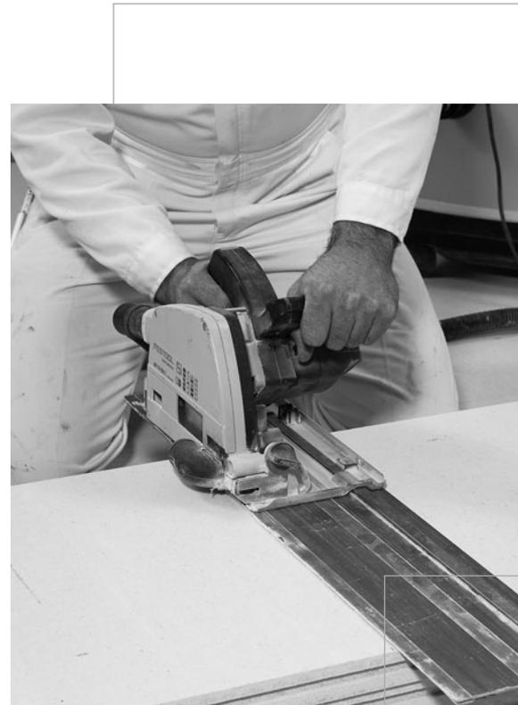
**Taglio con sega circolare dotata di lame con placchette di carburo metallico (HSS) e dispositivo di aspirazione**
